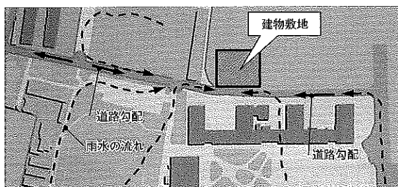
図1 道路勾配と雨水の流れ
